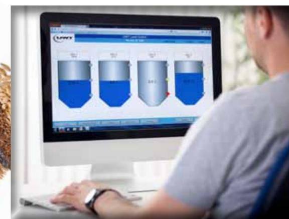
Il software di visualizzazione Nivotec® indica i livelli dei silo in tempo reale sul PC dell'operatore
