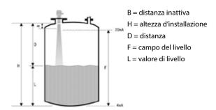
La velocità degli ultrasuoni nel gas è influenzata dalla relativa temperatura. Il misuratore deve rilevare la temperatura durante il funzionamento per compensare la velocità del suono.
