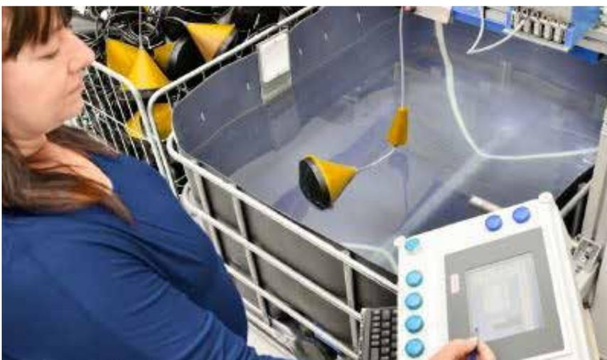
L'elevata qualità degli interruttori di livello KARI si basa sul sistema di qualità ISO 9001 ed è garantita anche dall'accurato controllo del prodotto. Ogni interruttore è sottoposto ad un collaudo funzionale completo.
