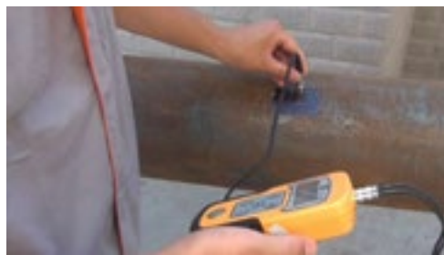
Misurare lo spessore del tubo con un misuratore di spessore
