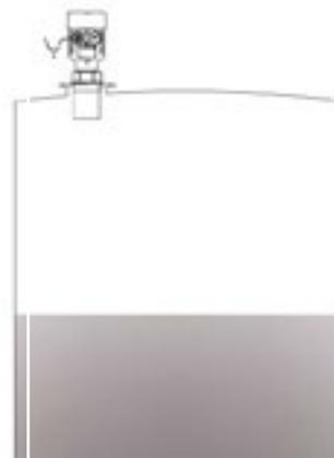
Se il sensore è installato all'esterno o in un ambiente umido, serrare saldamente il pressacavo. Il cavo deve formare un'ansa a forma di "U".
