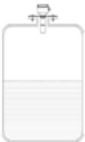
Se installato in luoghi caratterizzati da bassa temperatura, utilizzare una prolunga per il sensore così da estenderlo all'interno del serbatoio ed evitare il gelo.
