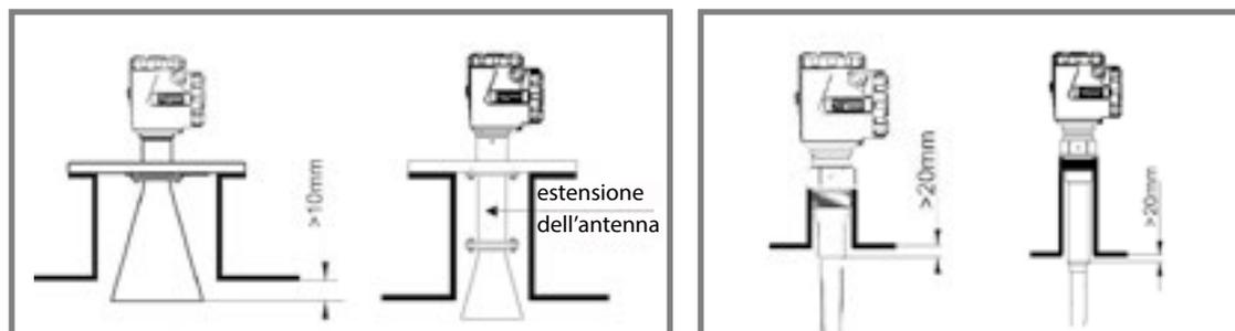
Nel caso di prodotti con forti caratteristiche riflettenti e di tronchetti di montaggio di grosso diametro, il misuratore può essere montato su tronchetti più alti della lunghezza dell'antenna.
