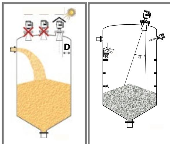
Nel caso di sili con prodotti solidi, installare il sistema di misura orientato verso lo scarico del prodotto. Con solidi che tendono a lasciare depositi, prevedere un sistema che semplifica la pulizia periodica dell'antenna. Tra tronchetto di montaggio e parete del serbatoio, si deve rispettare una distanza adeguata (in genere 1/6 del diametro del serbatoio e non inferiore a 300 mm/600 mm in base alle dimensioni dell'antenna).
