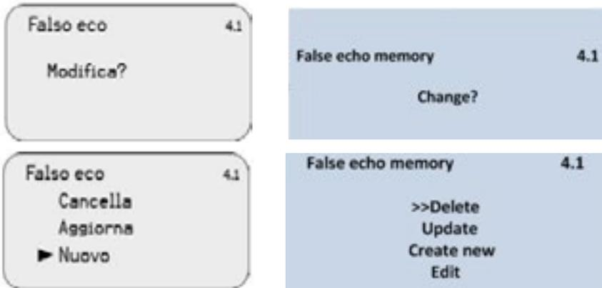
La condizione di livello 0% è ideale per memorizzare la curva dei falsi echi, perché il sistema è in grado di analizzare tutto il percorso del segnale radar e gli eventuali ostacoli presenti. Per aggiornare o memorizzare un nuovo eco, inserire la distanza reale che deve misurare il sensore.
