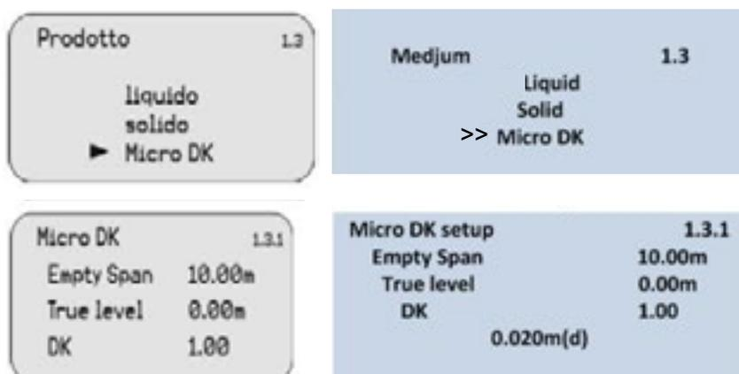
Accedere con Ok alla modifica del parametro, con il tasto Scorrimento selezionare il valore da modificare e con il tasto Freccia in alto impostare il valore. Confermare con OK.
