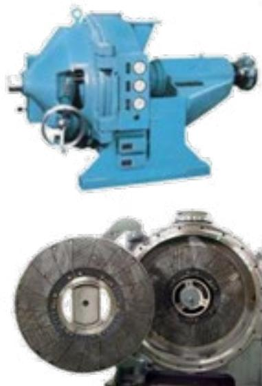
L'**affinamento** è una delle fasi più importanti nella produzione della carta in quanto influisce notevolmente sullo scorrimento della macchina continua e determina la qualità della carta e le sue proprietà finali. Dopo il trattamento, il prodotto presenta una migliore capacità di adesione delle fibre e una migliore stampabilità con inferiori rotture del nastro
