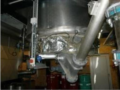
Un produttore di impianti di gassificazione a legno doveva applicare un allarme di vuoto in un reattore. Il sensore doveva rilevare in modo affidabile la cenere. La temperatura di processo arriva fino a 250°C.
