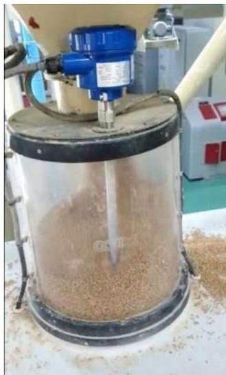
Uno dei principali produttori alimentari in Perù doveva controllare i variatori del sistema di macinazione, che modulano la velocità di riempimento e molitura. Il campo di misura richiesto era di 300 mm. L'uscita del segnale analogico doveva rispondere immediatamente, entro ca. 10 secondi, quando la tramoggia veniva caricata/scaricata. Il materiale è grano, che è leggermente abrasivo a causa dell'elevata portata del prodotto nella tramoggia.
