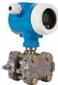
Il trasmettitore di pressione trasforma il segnale fisico di pressione, pressione differenziale e livello in un segnale standard grazie alla cella del sensore e all'elaborazione digitale dei segnali integrata. Viene compensato in fabbrica alla temperatura
