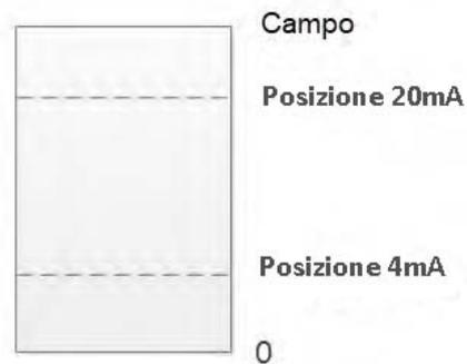
Come mostrato in figura, quando il livello del liquido è inferiore alla posizione 4mA, l'interfaccia principale visualizza il livello del liquido uguale a 0; quando il livello del liquido è superiore al punto 20 mA, l'interfaccia principale visualizza il valore del livello del liquido come valore del punto 20 mA.
