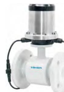
Ideale per la distribuzione dell'acqua e il trasferimento di acque reflue in località remote non elettrificate. I valori di portata possono essere monitorati da PC o smartphone mediante GPRS. Può misurare anche temperatura o pressione. Con 5 batterie al litio sostituibili da 3,6 V, la durata è di 8 anni. La custodia in SS304 con protezione IP68, può essere interrata o immersa.
