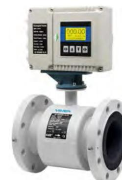
Il rumore è comune nei fluidi di processo con particolato solido e può inficiare la misura. Il misuratore, specifico per prodotti fangosi, grazie all'elevata eccitazione, a 25/30 Hz, elimina le interferenze dovute al rumore delle particelle solide, assicurando misure accurate con liquidi anche molto viscosi.
