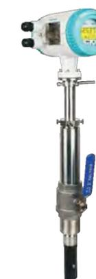
Disponibile per l'uso in tubi di dimensioni variabili da DN100 a DN3000. Può essere dotato di valvola a sfera filettata o flangiata "hot-tap", che consente di installare e rimuovere il sensore dal tubo senza arrestare il processo. Alternativa economica, se installato in tubi di grandi dimensioni, rispetto al misuratore di portata magnetico a passaggio pieno.
