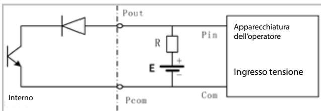
Fig. 7 Connessione dell'uscita di tensione digitale
