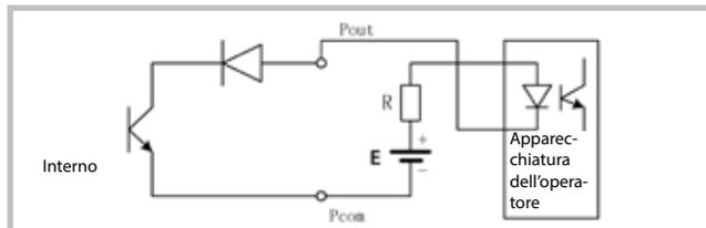
Fig. 8 Uscita digitale e connessione con raccordo fotoelettrico
