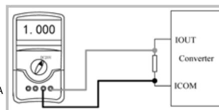
**Connessione dell'uscita in corrente del convertitore del misuratore**
