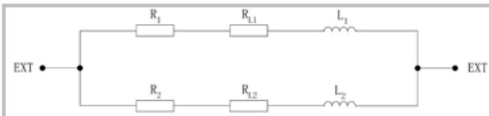
Resistenza totale =  $(R_1 + R_{L1})$  connessione in parallelo  $(R_2 + R_{L2}) \leq 120 \Omega$
