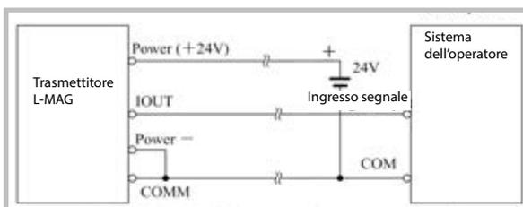
Fig. 11 Misuratore L-MAG, tre connessioni (alimentazione e uscita in corrente non sono isolate)
