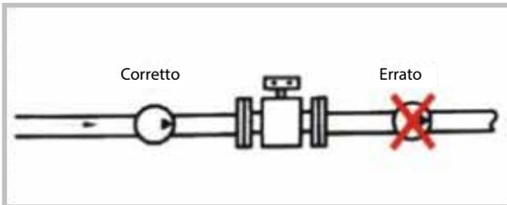
Non installare sul lato della pompa
