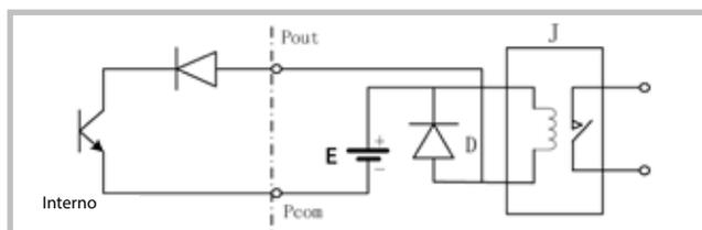
Fig. 9 Uscita digitale e connessione con relè
