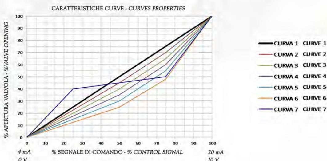
LE CURVE POSSONO ESSERE UTILIZZATE PER PERSONALIZZARE A PARITÀ DI SEGNALE ELETTRICO DI COMANDO IL TIPO DI APERTURA E CHIUSURA DELLA VALVOLA TRAMITE IL DISPOSITIVO.
